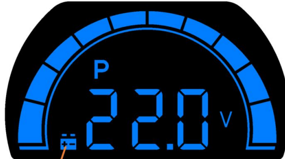
Spannungsalarm-Symbol aktiviert (Spannungsalarm-Einstellung abgeschlossen)
